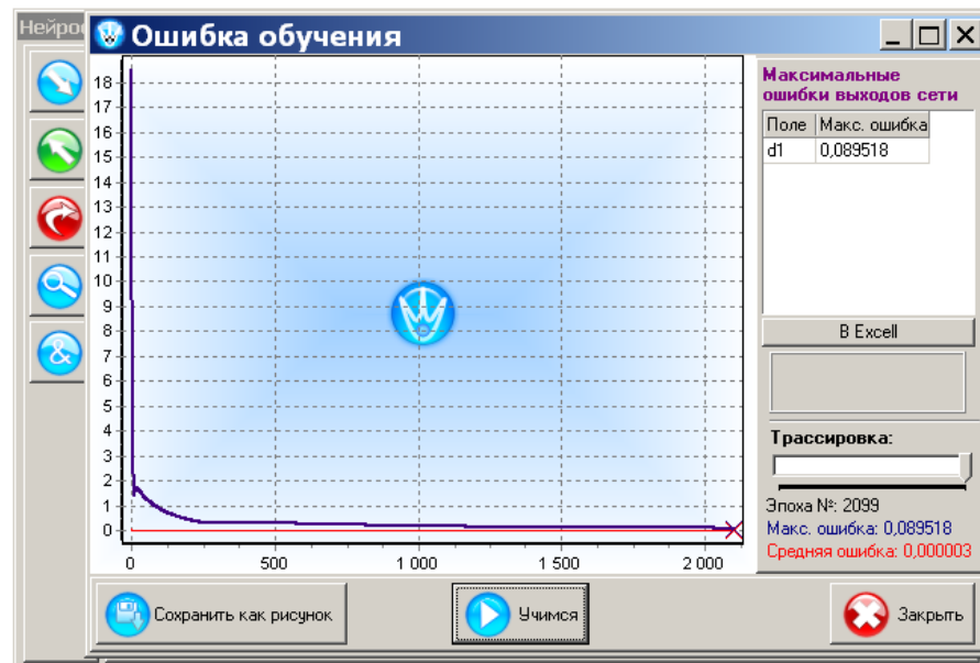
Рис. 7. Графическое отображение процесса обучения сети с семью нейронами скрытого слоя
